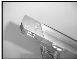
Tense los cables de transmisión con la ayuda de unas tenazas y atornillelos en la placa de
